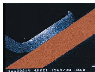
Obraz mikroskopowy aluminiowych lameli osadzonych na miedzianej rurce
